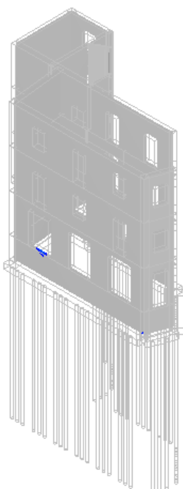
TENSIONE DI TRAZIONE (DIREZIONE ORIZZONTALE) ECCEDENTE LE RESISTENZE DI CALCOLO
