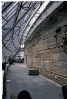
L'ospedale di Feldkich, Austria, rappresenta una evoluzione dello stile di Rauch. La parete del solarium funziona anche da massa di accumulo del calore.
